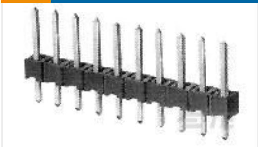
TE 系列/零件编号103747-5 05 MODII HDR SRST B/A . 100CL
